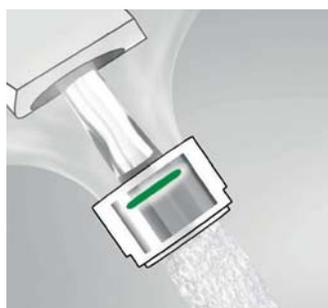
Tandis qu'un mitigeur de **lavabo traditionnel** consomme approximativement **13 L/min d'eau**, un **mitigeur EcoSmart ne consomme que 5 L/min**, et ce, quel que soit le niveau de pression! En effet, un mousseur EcoSmart est intégré sur le bec de la robinetterie, limitant le débit et enrichissant l'eau en air.
