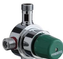
■ 55 l/min ■ Pour la distribution d'eau mitigée, butée de température ■ Plage de réglage de 35 à 55 °C ■ Entrées et sortie G 3/4" ■ Filtrés et clapets anti-retour NF
