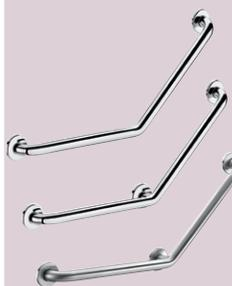
■ Ø 32, pour PMR ■ 2 points de fixation ■ Utilisation comme barre d'appui (partie horizontale) ou de relèvement (partie à 135°) ■ Utilisation indifféremment à gauche comme à droite ■ Dimensions : 400 x 400 mm, tube inox 304 bactériostatique ■ Écartement entre la barre et le mur de 40 mm ■ Fixations invisibles par platine 3 trous, inox 304, Ø 72 ■ Platinet et caches en inox 304, vis inox pour mur béton ■ Testée à plus de 200 kg, maximum utilisateur recommandé 135 kg ■ CE, garantie 10 ans
