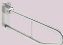
■ Barre maintien 135° montage mural en inox avec finition satinée ■ Micro-rainures pour une meilleure prise en main ■ Tube Ø 32 mm, épaisseur 1,2 mm, deux rosaces plates en inox ■ Vis inox et chevilles fournies ■ Dimensions 696 x 334 x 82 mm (L x H x P)
