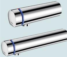
■ Longueur 110 mm ■ Réglage de la température et déclenchement sur le croisillon ■ Temporisation ~7 secondes, débit préréglé à 3 l/min à 3 bar, ajustable de 1,5 à 6 l/min ■ Brise-jet antitartre inviolable ■ Fixation murale M1/2" ■ Arrivées d'eau encastrées ■ Filtres et clapets anti-retour ■ Butée de température réglable ■ Garantie 10 ans
