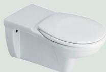
■ 700 x 355 mm ■ Avec trous d'abattant ■ A équiper d'une manchette d'alimentation rallongée 40 cm recoupable (D90A267NU) et d'un joint Sirius ■ A équiper de l'abattant simple avec ergots de blocage latéral S406901 ou S406601 ■ A équiper de l'abattant P504201 ou S406801 ■ Plaque arrière surélevée anti-infiltration
