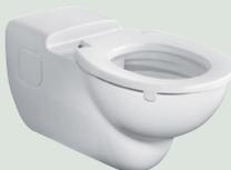
■ 70x36 cm ■ Sans bride, circuit de rinçage totalement ouvert et émaillé pour un nettoyage optimal ■ Avec trous d'abattant ■ Fixation par tire-fond ou sur bâti-support (non fourni), cache fixation fourni ■ Plaque arrière surélevée anti-infiltration ■ A équiper d'une manchette d'alimentation rallongée 40cm recoupable (D90A267NU) et d'un joint Sirius ■ A équiper de l'abattant simple avec ergots de blocage latéral S406901 ou S406601 ou S406801
