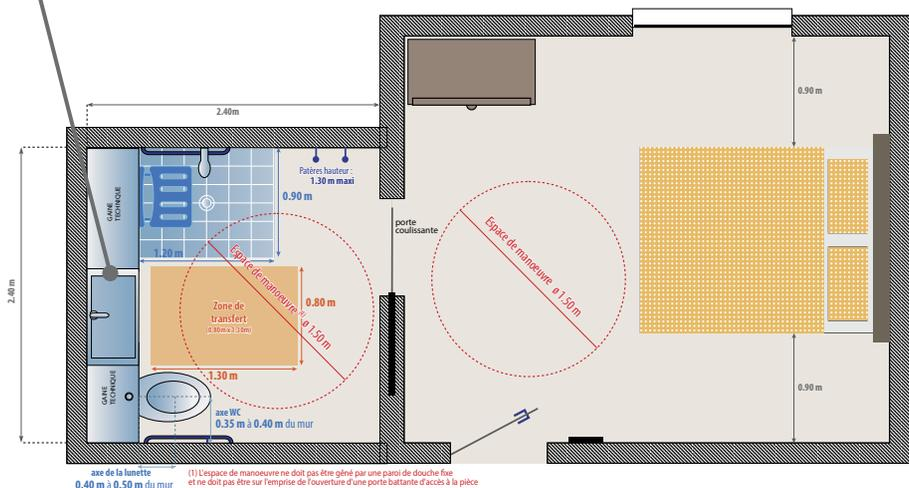
(1) L'espace de manœuvre ne doit pas être gêné par un panneau de douche fixe et ne doit pas être sur l'emprise de l'ouverture d'une porte battante d'accès à la pièce
